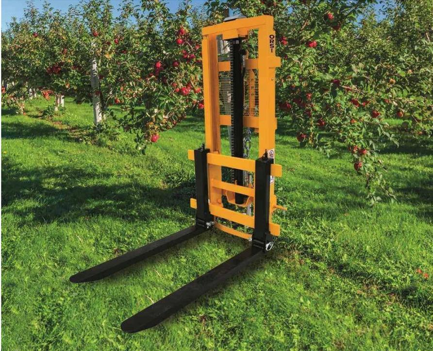
Elevatore idraulico con forche pieghevoli e pattini lunghi in arnite antiusura e autolubrificanti che permettono al distributore di essere spostato. Distributore predisposto ad ulteriore movimento, cilindro sul 3° punto, stringicarico, gancio di traino, catene di sollevamento e valvola di sicurezza sul cilindro d'alzata e brandeggio.
